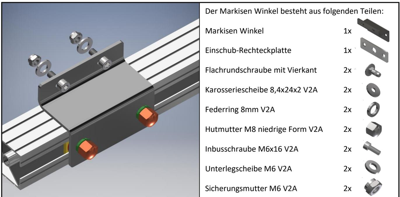
Bitte beachten Sie, dass lediglich die Rechteckplatte (mit Schrauben) in das Profil eingeschoben werden darf.
